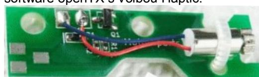
Existuje i množství zapojení s 3-4 odpory a 1 tranzistorem, 1 diodou a vibračním motorem 1,5-3,3V a cca 20-50mA.
