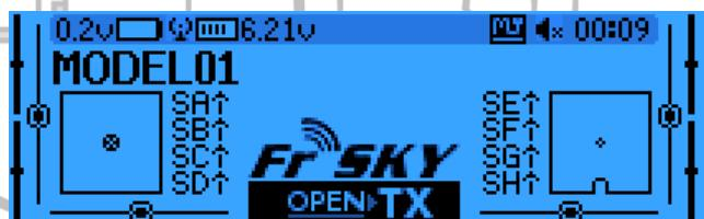
Třetí obrazovka znovu zobrazuje fyzické přepínače na levé straně, a stav 32 logických (virtuálních) přepínačů na pravé straně.
